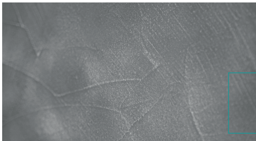
DOPPO AMBIENTE PRO+ Oberfläche mit Spachtelstruktur und anschließendem Endschliff*
